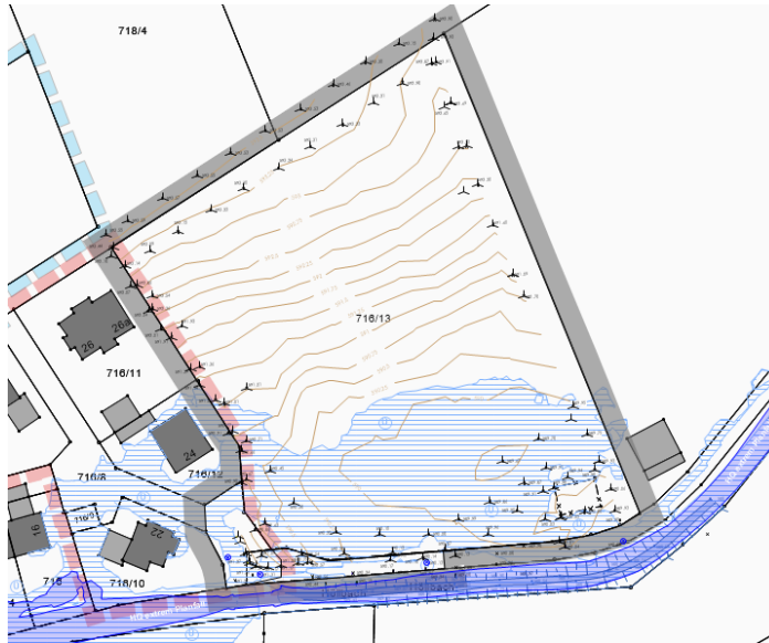
Abb. 8 blau schraffierte Fläche: Hochwassergefahrenfläche HQ 100, aktuell; dunkelblaue Fläche: HQ extrem Planfall; Plandarstellung: PV, 2023
