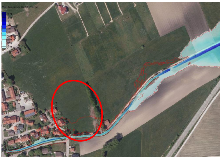
Abb. 6 Planzustand hydraulisches Modell Überschwemmungsfläche HQ 100 (blau: neu, rot: bisherige Linie); Quelle: IB Steinbacher Consult, Stand: 05.06.2023
