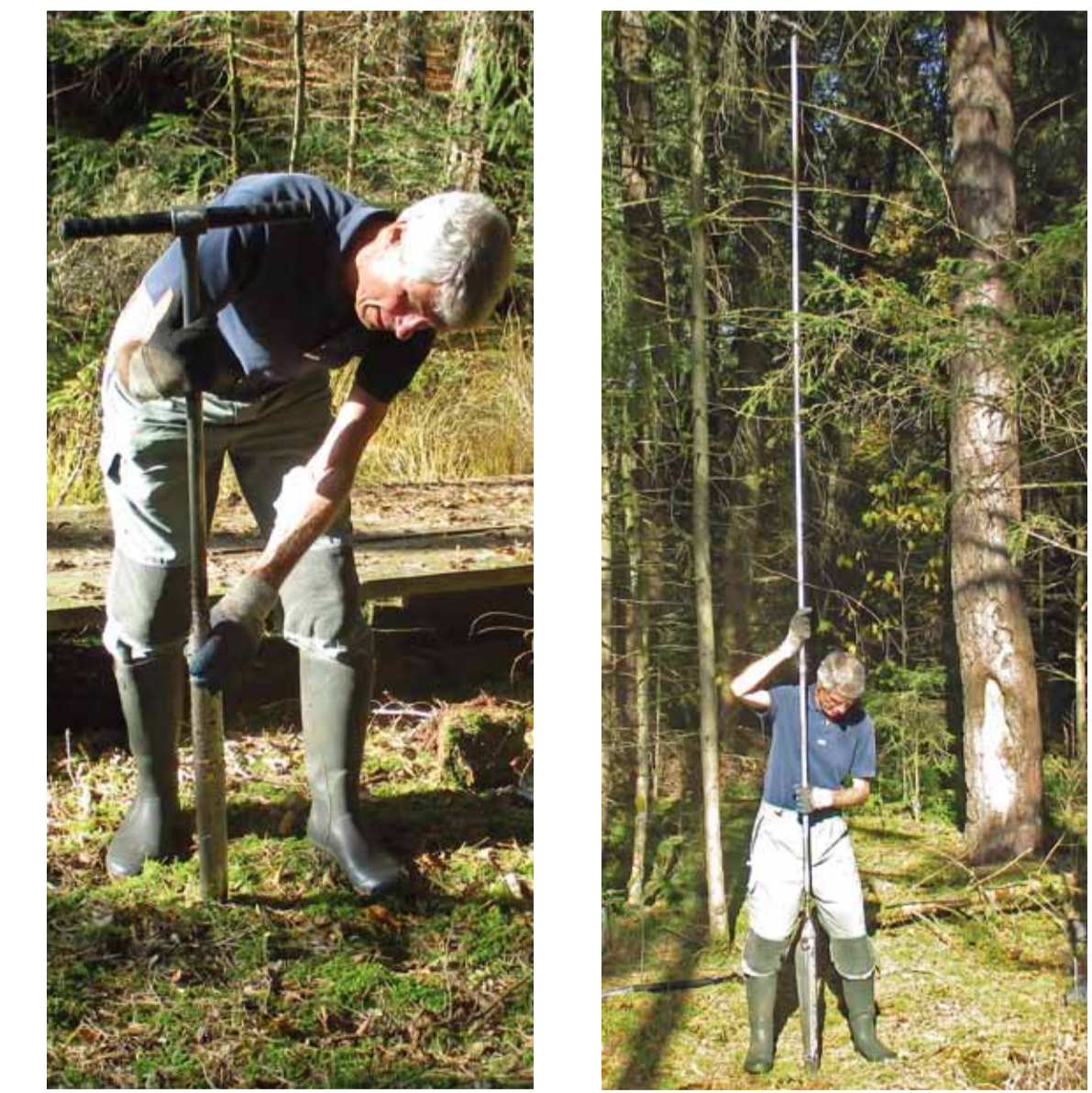
Abb. 5 und 6: Hier ist der Einsatz eines speziellen Moorbohrers zu sehen, der von Hand in den Boden gedrückt wird. Der Teil, der die Bodenprobe enthält, ist ein Halbzylinder. Wie im rechten Bild zu sehen ist, kann der Bohrer meterweise von oben verlängert werden. Hierdurch kann die Art des Bodens bestimmt und Bodenprofile erstellt werden.
