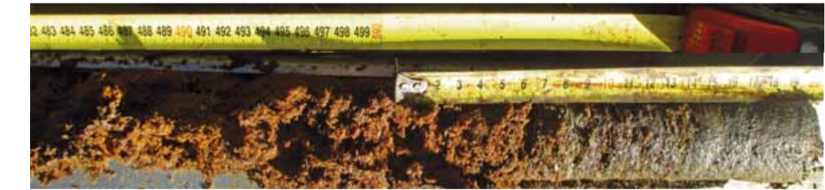
Abb. 9: Unterste Bodenschicht (4,80 bis 5,20 Meter); rechts ist die hellgraue Tonschicht zu sehen
